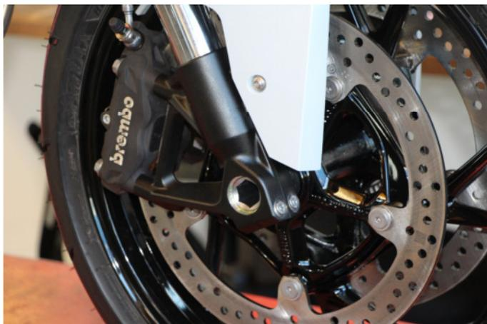
Das vormontierte Pad mit der Gewindestange von rechts durch die Achse schieben.
