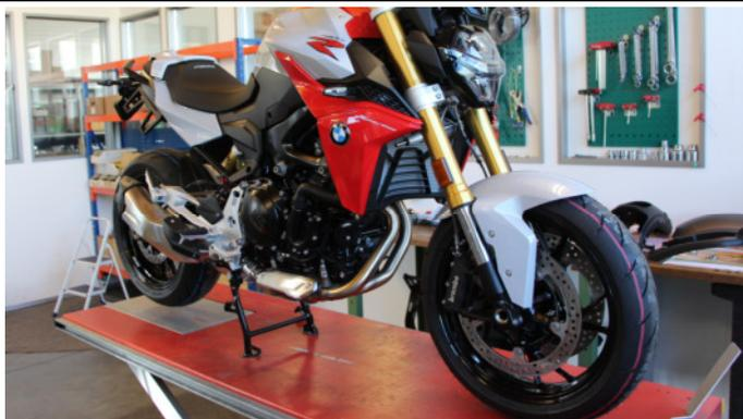
Die Auflageflächen der Pads am Standrohr und der Achse links und rechts reinigen.
