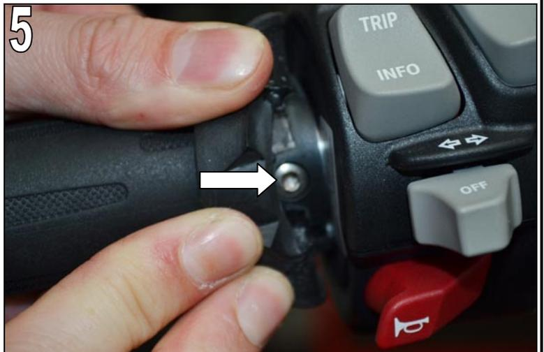
An Fahrtrichtung rechte Seite: Mit Torxdreher TX8 durch die Öffnung in der Abdeckung der Elektroeinheit die Befestigungsschraube der Abdeckung lösen und Abdeckung abnehmen. (Abb. 6)
